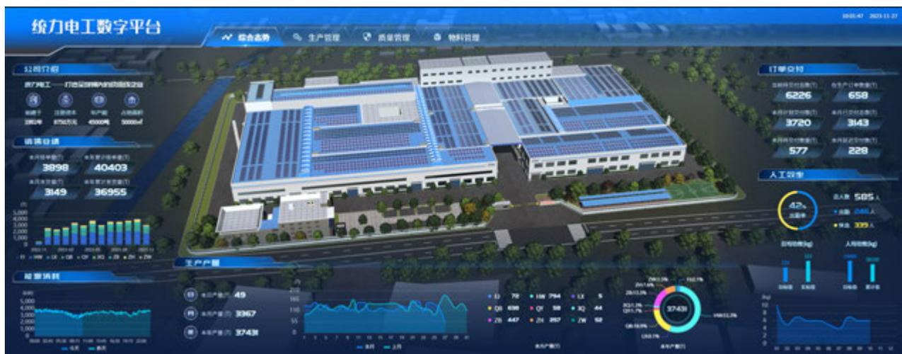
智改数转再上台阶，搭建数字孪生平台，为生产决策提供数字支持。在换位生产线探索充分利用物联网技术，搭载 IoT 网关，采用数据处理器将采集到换位机各个设备环节的状态数据进行综合处理，识别出运行、调整、待机、质量、故障、计划停机等设备状态。通过数字技术同步复原换位机的运行状态，在此基础上提高换位产品的加工过程能力和订单履约能力提高。创新开发 MES 系统视觉在线检测模块，实现检测数据与 MES 系统互联，对产品质量具备了自动判断功能。
